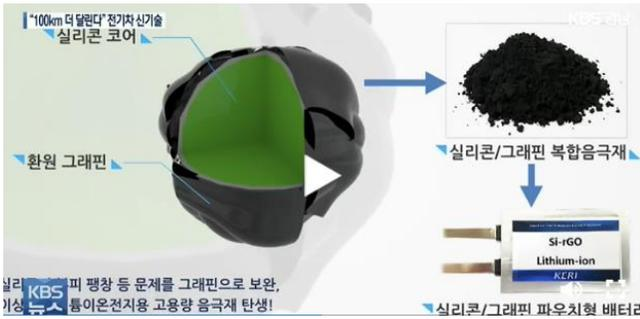
그림 18 그래핀이 실리콘을 감싸는 Core-Shell 구조
